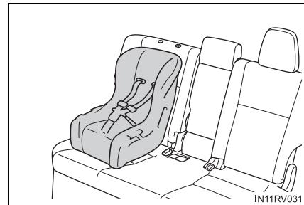
Si votre dispositif de retenue pour enfants est gêné par un appuie-tête et ne peut pas être installé correctement, installez-le après avoir retiré l'appui-tête. (→P.162)
