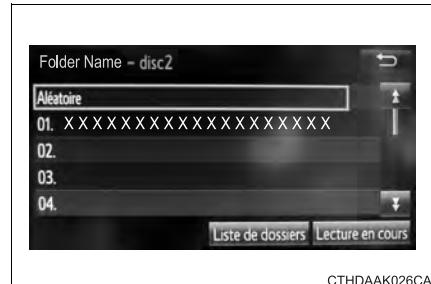
Vous pouvez sélectionner le dossier, lorsqu'un disque MP3/WMA/AAC ou un périphérique de stockage USB sont utilisés. Vous pouvez sélectionner l'album, lorsqu'un dispositif Bluetooth® ou un iPod est utilisé.
