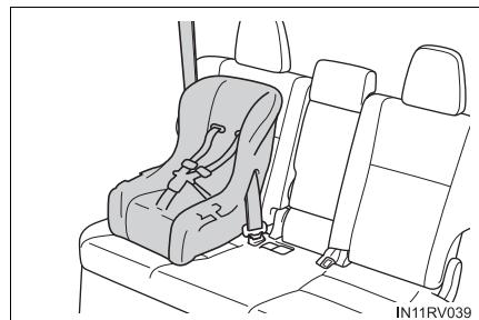
**2** Fixez le crochet au support d'ancrage et tendez la courroie supérieure.
