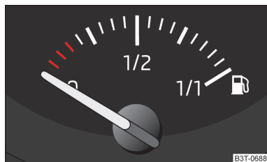
Fig. 5 Niveau du réservoir
