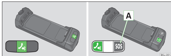
Fig. 115 Schéma du principe : Adaptateur à une touche/adaptateur à deux touches
