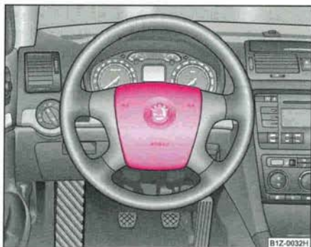
Fig. 156 Sac gonflable du conducteur dans le volant
