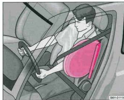
Fig. 161 Sacs gonflables latéraux remplis de gaz
