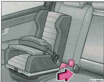
Fig. 174 Les sièges pour enfants ISOFIX sont insérés dans les ergots déjà montés
