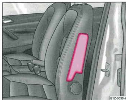
Fig. 160 Emplacement des sacs gonflables latéraux dans le siège du conducteur
