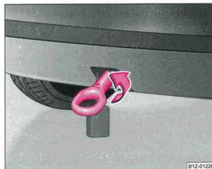
Fig. 211 Pare-chocs AR: Pose des oeilllets de remorquage
