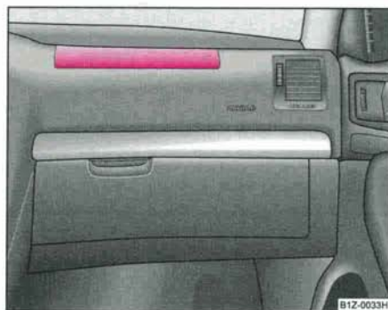
Fig. 157 Sac gonflable du passager avant dans tableau de bord
