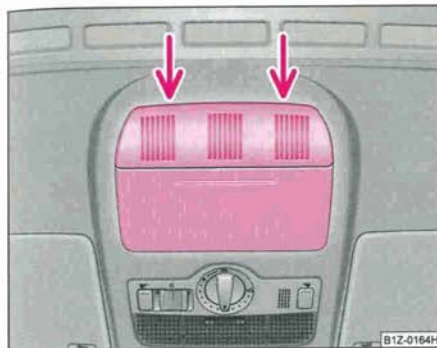
Fig. 39 Partie du revêtement de pavillon: Point d'introduction du tournevis
