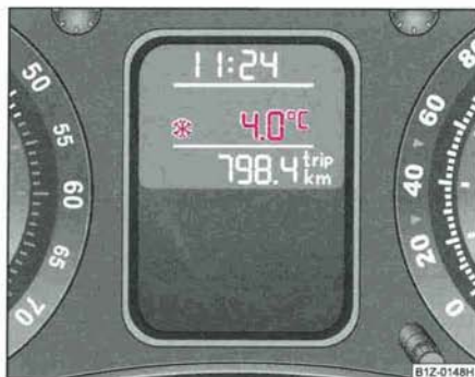
Fig. 7 Indicateur multifonctions: La température extérieure
