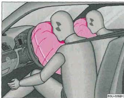
Fig. 158 Sacs remplis de gaz
