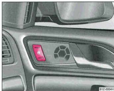
Fig. 37 Disposition du contacteur dans la porte du passager avant
