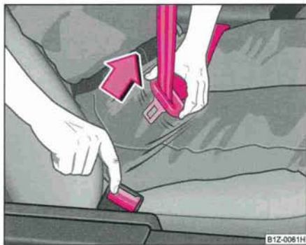
Fig. 155 Enlever le pêne du boîtier de verrouillage
