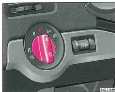
Fig. 42 Tableau de bord: Commutateur d'éclairage
