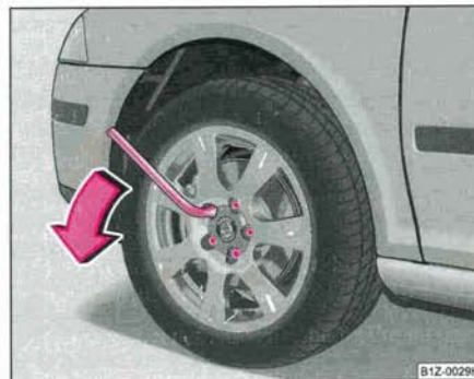
Fig. 204 Changement de roue: Desserer un peu les boulons de roue
