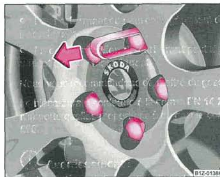
Fig. 202 Dépose du chapeau de roue
