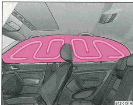
Fig. 163 Airbag de tête rempli de gaz
