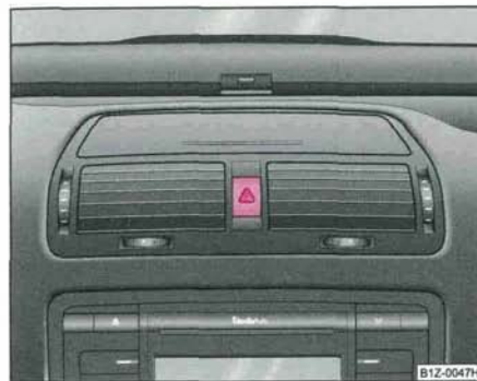
Fig. 46 Tableau de bord: Contacteur pour feux de détresse
