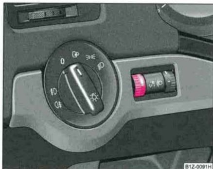
Fig. 44 Tableau de bord: Eclairage de l'instrumentation
