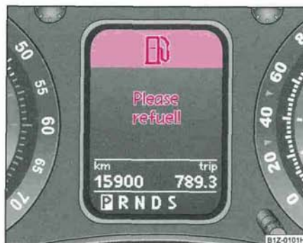
Fig. 18 Ecran d'informations: Peu de carburant dans le réservoir
