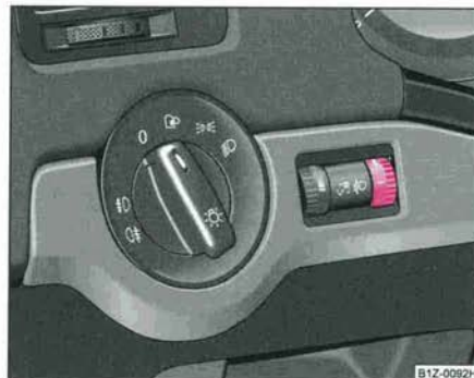
Fig. 45 Tableau de bord: Réglage de la portée des phares
