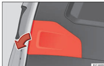
Fig. 110 Coffre à bagages ouvert : retirer le cache.
