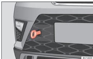
Fig. 74 Pare-chocs avant droit : œillet de remorquage vissé
