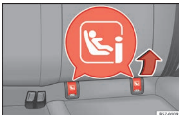
Fig. 31 Anneaux de fixation ISOFIX/iSize.
