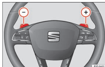
Fig. 168 Volant : palettes pour boîte automatique.
