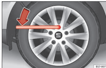
Fig. 71 Roue : desserrer les vis de roue.
