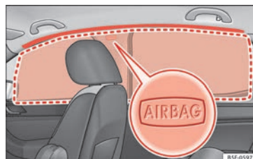
Fig. 27 Emplacement des airbags rideaux.
