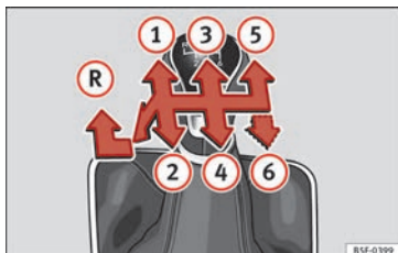
Fig. 52 Schéma d'une boîte mécanique 5 vitesses ou 6 vitesses.
