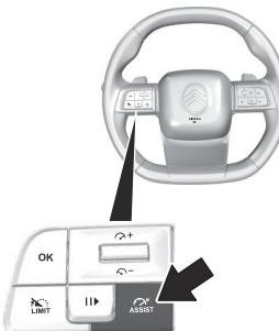
► Faire des appuis successifs sur ce bouton jusqu'à l'affichage du mode Aide au conducteur sur l'autoroute au combiné d'instruments.
