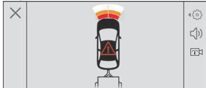
**!** L'aide au stationnement arrière est désactivée automatiquement en cas de branchement d'une remorque ou d'un porte-vélo sur un dispositif d'attelage installé selon les préconisations du Constructeur.
