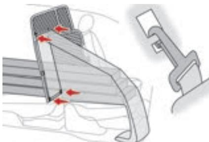
► Installer la housse de protection en fixant les 4 mousquetons de la housse sur les 4 pièces situées sur la cloison.
