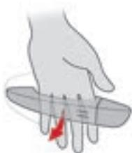
► Pour déverrouiller le véhicule, télécommande sur soi dans la zone de reconnaissance **A**, passer la main derrière l'une des poignées (porte[s] avant et porte[s] latérale[s] coulissante[s] manuelle[s] ou portes battantes).
