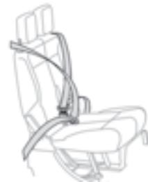
Si le véhicule est équipé d'une banquette avant, veiller à mettre la bonne ceinture avec le bon boîtier de verrouillage.
