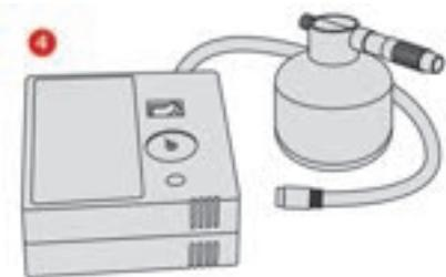
4. Compresseur 12 V avec cartouche de produit de colmatage et autocollant de limitation de vitesse
