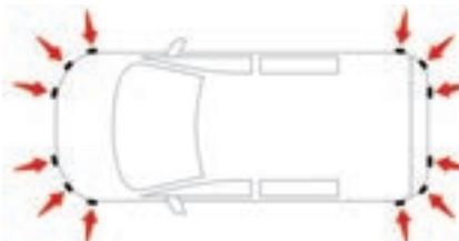
Ce système détecte et signale la proximité d'obstacles (ex. : piéton, véhicule, arbre, barrière) à l'aide de capteurs situés dans le pare-chocs.
