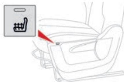
▶ Environ 30 secondes après le démarrage du moteur, appuyer sur la commande. Il est possible de l'activer dès que la température extérieure descend au-dessous de 20 °C. La température est régulée automatiquement. Une nouvelle pression interrompt le fonctionnement.
