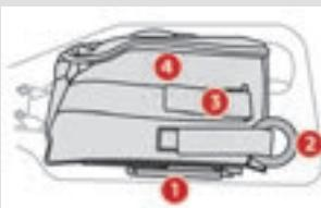
L'espace au niveau des pieds du passager est étroit. Pour arriver à fermer le portillon, ranger les outils à leur emplacement d'origine : la cale **1** à l'extérieur du sac, l'anneau amovible **2** au-dessus du sac avec la boucle orientée vers l'extérieur, la clé Torx **3**
