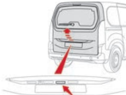
► Pour déverrouiller le véhicule, télécommande dans la zone de reconnaissance **A**, appuyer sur la commande de déverrouillage du volet de coffre.
