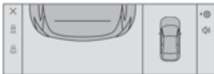
La caméra arrière enregistre les alentours lors de la manœuvre pour créer une vue de dessus arrière du véhicule dans son environnement
