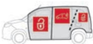
Le déverrouillage sélectif permet de déverrouiller soit les portes de la **cabine**, soit les ouvrants de la **zone de chargement** (latéraux et arrière).
