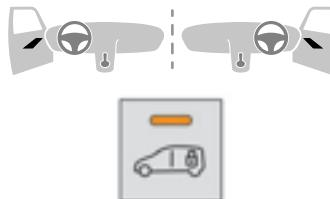
► Pour **activer** le déverrouillage **sélectif** entre **cabine** et **zone de chargement** ou pour **désactiver** cette sélectivité et revenir au déverrouillage **total**, mettre le contact et appuyer plus de deux secondes sur ce bouton. Un signal sonore et, selon l'équipement, l'affichage d'un message confirme la prise en compte de la demande.
