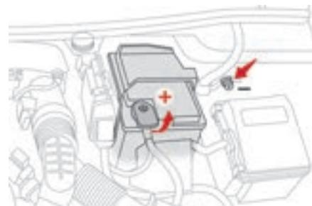
La borne (-) de la batterie n'est pas accessible. Un point de masse déporté est implanté à proximité de la batterie.
