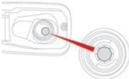
Lors de l'introduction dans le réservoir Diesel, le pistolet essence vient buter sur le volet. Le système reste verrouillé et empêche le remplissage.
