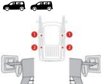
Accroché aux fixations hautes et aux anneaux inférieurs ou aux ergots, il permet d'utiliser tout le volume de chargement jusqu'au pavillon :
