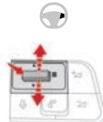
**À l'arrêt**, utiliser le bouton de basculement à droite du volant pour ouvrir le menu Réglages, puis basculer le bouton vers le haut ou vers le bas pour naviguer dans les menus afin de configurer certains paramètres du véhicule.
