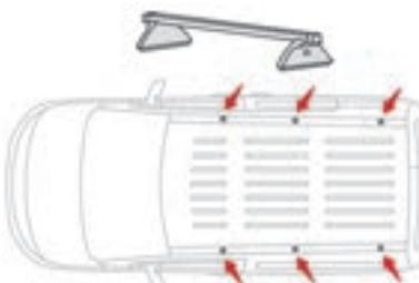
Pour installer les barres de toit transversales ou une galerie, utilisez les fixations prévues à cet effet :
