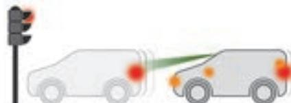
Cette fonction, également appelée "freinage automatique d'urgence", intervient après l'alerte sonore si le conducteur n'appuie pas assez vite sur la pédale de frein.
