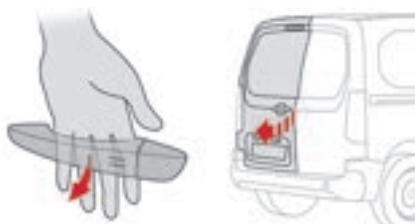
► Pour déverrouiller le véhicule, télécommande dans la zone de reconnaissance **A**, passer la main derrière la poignée de la porte battante.
