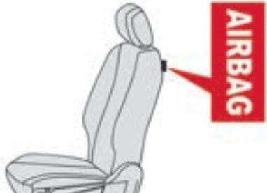
Ce système protège, en cas de choc latéral violent, le conducteur et le passager avant afin de limiter les risques de traumatisme au thorax, entre la hanche et l'épaule. Chaque airbag latéral est intégré dans l'armature du dossier de siège, côté porte.
