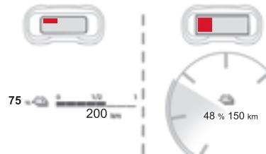
Le niveau de charge réel de la batterie de traction et l'autonomie restante sont affichés en permanence lorsque le véhicule est démarré.
