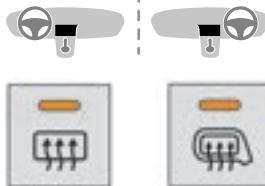
► Appuyer sur l'un de ces boutons pour mettre en marche / arrêter le désembuage / dégivrage de la lunette et des rétroviseurs extérieurs (selon version).
