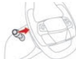
► Contact coupé, tirer la commande d'éclairage ("appel de phares") vers soi pour mettre en service / arrêter la fonction. L'éclairage d'accompagnement manuel s'arrête automatiquement au bout d'un certain temps.
