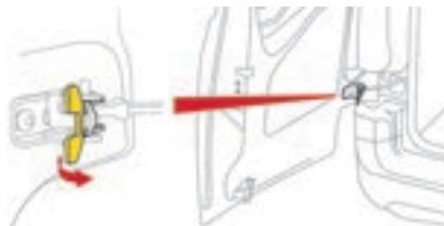
Si vous en êtes équipé, un système de tirant permet de porter l'ouverture d'environ 90° à environ 180°.
