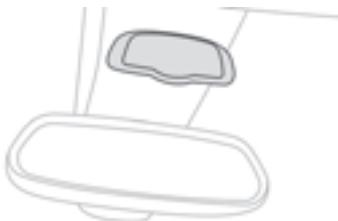
Un miroir de surveillance enfants est implanté au dessus du rétroviseur intérieur. Il permet de veiller sur les passagers arrière du véhicule ou de faciliter la discussion entre les passagers avant et arrière sans modifier le réglage du rétroviseur et sans se retourner. Il peut s'escamoter pour éviter les éblouissements.
