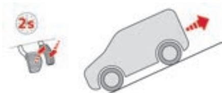
**En pente descendante, véhicule à l'arrêt et marche arrière engagée, le véhicule est maintenu un court instant dès que le conducteur relâche la pédale de frein.**
