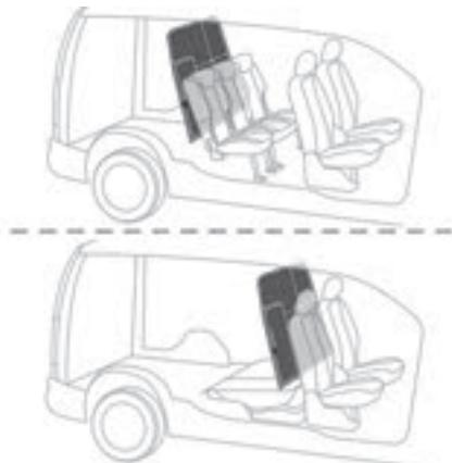
Une cloison mobile, pouvant se positionner derrière le rang 2 ou le rang 1, protège le conducteur et les passagers contre les risques de déplacement de charges.
