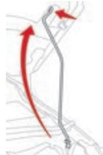
► Déclipper la béquille de son logement et la fixer dans le cran pour maintenir le capot ouvert.
