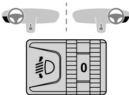
Pour ne pas gêner les autres usagers de la route, les projecteurs à lampes halogènes doivent être réglés en hauteur, en fonction de la charge du véhicule.
