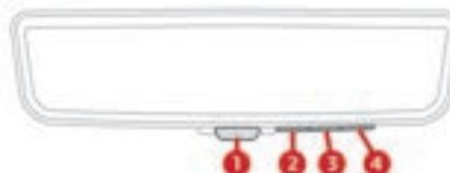
**1.Basculer du mode numérique au mode optique et inversement**
