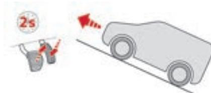
**En pente montante, véhicule à l'arrêt, le véhicule est maintenu un court instant dès que le conducteur relâche la pédale de frein :**
