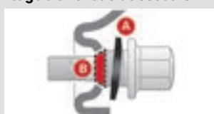
Dans le cas des roues aluminium, les rondelles **A** ne viennent pas en contact avec la roue de secours tôle. Le maintien de la roue se fait par l'appui conique **B** de chaque vis.
