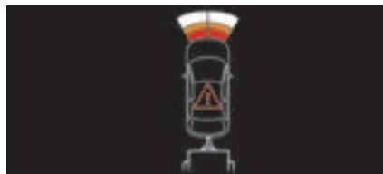
**i** L'aide au stationnement arrière est désactivée automatiquement en cas de branchement d'une remorque ou d'un porte-vélo sur un dispositif d'attelage installé selon les préconisations du Constructeur. Dans ce cas, le dessin d'une remorque s'affiche à l'arrière de la représentation du véhicule.
