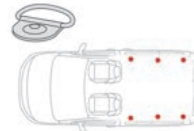
Utiliser les anneaux d'arrimage sur le plancher arrière pour fixer les charges.
