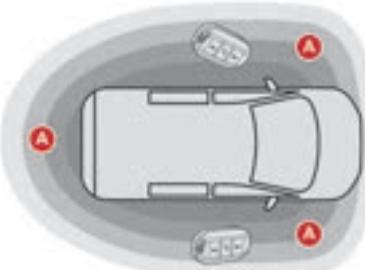
Elle permet le déverrouillage, le verrouillage et le démarrage du véhicule en gardant la télécommande sur soi dans la zone de reconnaissance "A".
