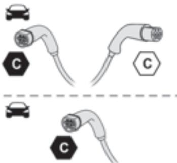
Étiquettes d'identification **C** sur le connecteur de charge (côté véhicule) et sur la prise (côté chargeur).
