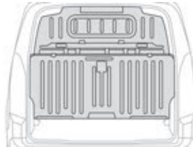
Sur le plancher, derrière les sièges avant, une séparation verticale protège le conducteur et les passagers avant contre les risques de déplacement de charge.
