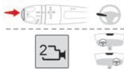
► **Pour afficher la vue latérale**, appuyer sur l'extrémité de la commande d'éclairage ou sur le bouton correspondant **4** situé sous le rétroviseur intérieur.
