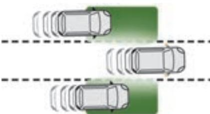
Ce système avertit le conducteur d'un danger potentiel posé par la présence d'un autre véhicule (automobile, camion, moto) dans les angles morts du véhicule (zones masquées du champ de vision du conducteur) à l'aide de capteurs aménagés sur les côtés des pare-chocs.
