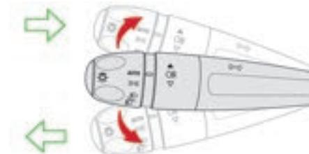
► Gauche ou droit : abaisser ou relever la commande d'éclairage en dépassant le point de résistance.
