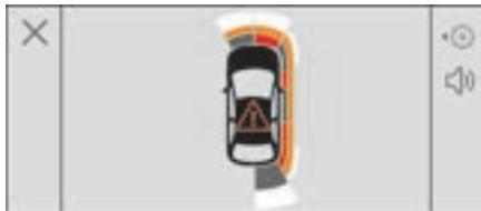
À l'aide de 4 capteurs supplémentaires aménagés sur les côtés des pare-chocs, le système enregistre la position des obstacles au cours de la manœuvre et les signale lorsqu'ils sont situés au niveau des côtés du véhicule.
