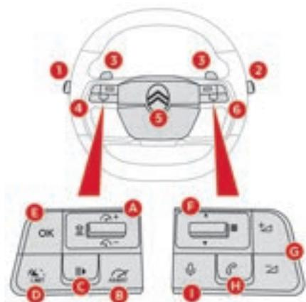
1. Commandes d'éclairage extérieur / Indicateurs de direction/ Commande d'affichage avec Dynamic Surround Vision
