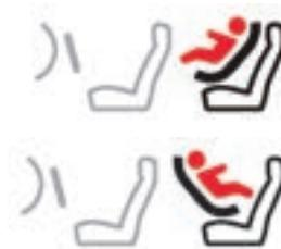
► Avancer le siège avant du véhicule et redresser le dossier de sorte que les jambes de l'enfant installé dans le siège enfant face à la route ou que le siège enfant dos à la route ne touchent pas le siège avant du véhicule.
