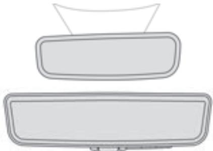
Le système électrochrome utilise un capteur qui prend en compte le niveau de luminosité extérieure, et celui provenant de l'arrière du véhicule, pour assurer automatiquement et progressivement le passage entre les utilisations jour et nuit.
