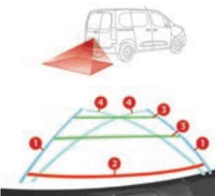
Les traits bleus **1** représentent la direction générale du véhicule (l'écart correspond à la largeur de votre véhicule avec les rétroviseurs).
