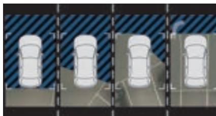
À l'aide de la caméra, les alentours proches du véhicule sont enregistrés pendant les manœuvres à basse vitesse.
