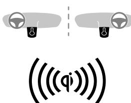
Ce système recharge sans fil des appareils nomades tels que les smartphones, en utilisant le principe de l'induction magnétique, selon la norme Qi.
