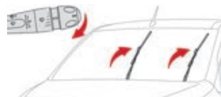
Immédiatement après la coupure du contact, toute action sur la commande d'essuie-vitre positionne les balais verticalement.
