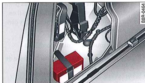
Fig. 226 Coffre à bagages, côté gauche : compresseur
