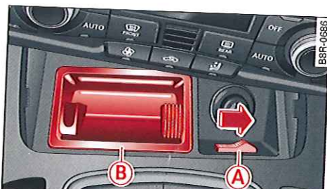
Fig. 112 Console centrale avant : extraction du boîtier de cendrier
