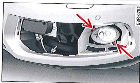
Fig. 260 Phare antibrouillard : vis de fixation
