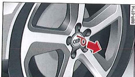
Fig. 217 Roue : enjoliveur de roue central
