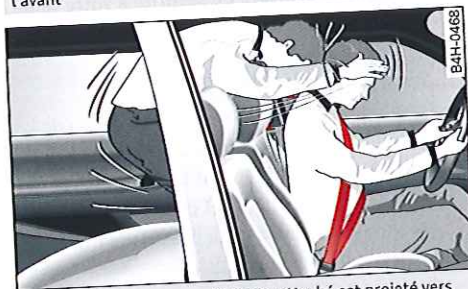
Fig. 176 Le passager arrière non attaché est projeté vers l'avant
