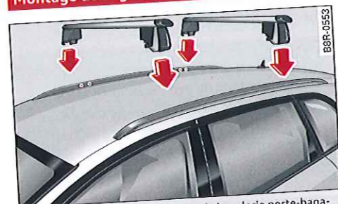
Fig. 90 Barres de toit : montage de la galerie porte-bagages
