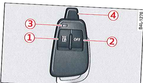
Fig. 95 Radiocommande pour chauffage/ventilation stationnaire
