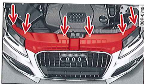
Fig. 243 Cache : repérage des fixations
