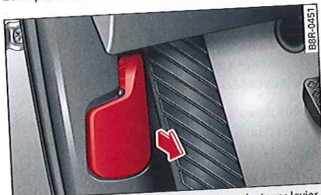
Fig. 199 Vue partielle du plancher côté conducteur : levier de déverrouillage
