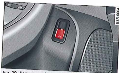
Fig. 29 Porte du conducteur : déverrouillage du hayon
