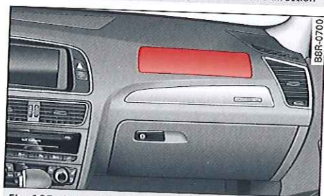
Fig. 185 Airbag passager avant intégré au tableau de bord
