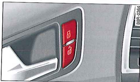
Fig. 24 Porte du véhicule : commande de verrouillage centralisé
