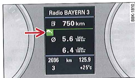
Fig. 15 Combiné d'instruments : programme d'efficacité
