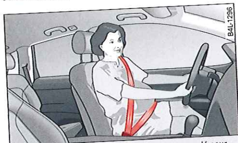
Fig. 180 Positionnement des sangles recommandé pour les femmes enceintes
