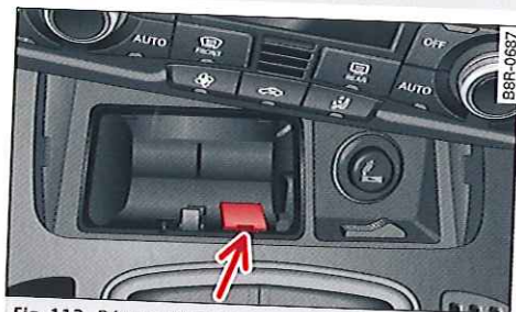
Fig. 113 Déverrouillage d'urgence du levier sélecteur
