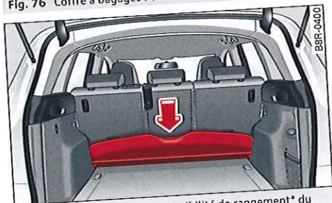
Fig. 77 Coffre à bagages : possibilité de rangement* du couvre-coffre
