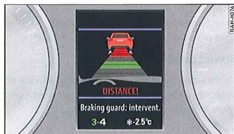
Fig. 139 Combiné d'instruments : avertissement de collision
