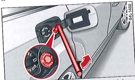
Fig. 197 Côté arrière droit du véhicule : dévissage du bouchon d'obturation du réservoir d'AdBlue
