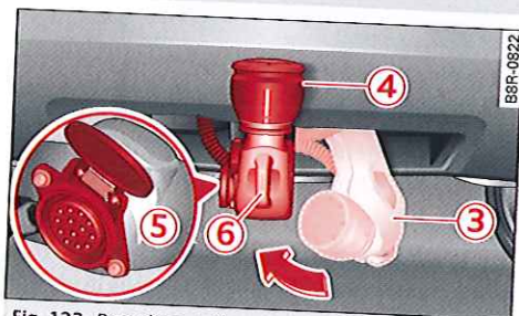
Fig. 123 Pare-chocs arrière : encliquetage du dispositif d'attelage et ouverture de la prise de courant
