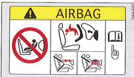
Fig. 183 Pare-soleil côté passager avant : autocollant de l'airbag
