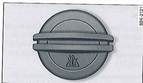
Fig. 204 Compartiment-moteur : couvercle du vase d'expansion de liquide de refroidissement
