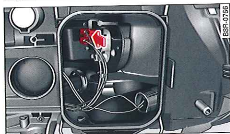
Fig. 250 Phare principal : ampoule du feu de route
