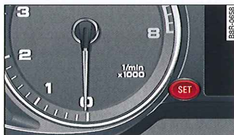
Fig. 4 Combiné d'instruments : touche SET
