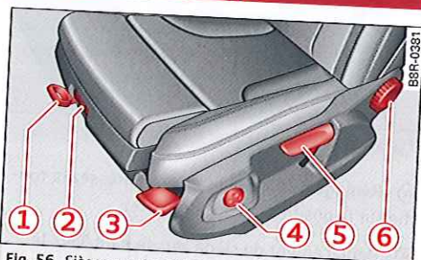
Fig. 56 Sièges avant : réglage manuel
