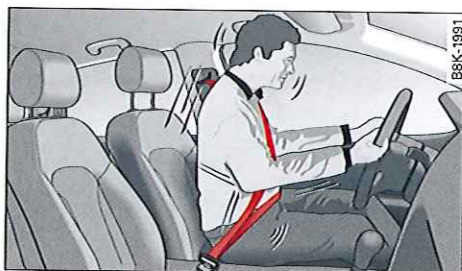
Fig. 172 Conducteur attaché, retenu en cas de freinage brusque par la ceinture correctement positionnée.
