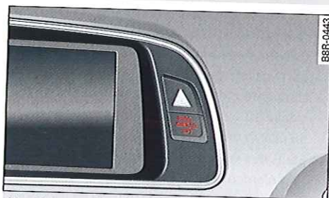
Fig. 193 Poste de conduite : témoin de désactivation de l'airbag passager
