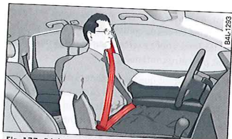
Fig. 177 Réglage de l'appui-tête et positionnement de la sangle
