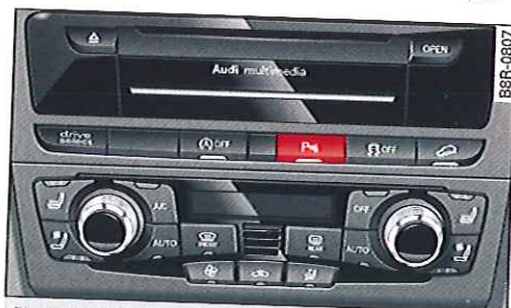
Fig. 151 Console centrale : touche d'aide au stationnement
