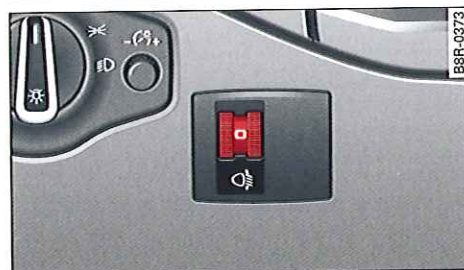
Fig. 39 Tableau de bord : molette de réglage du site des phares*
