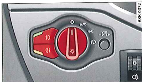
Fig. 38 Tableau de bord : commande d'éclairage
