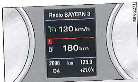
Fig. 128 Combiné d'instruments : vitesse sélectionnée
