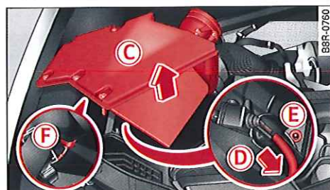
Fig. 246 Dépose du corps de filtre à air
