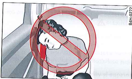
Fig. 167 Représentation schématique d'une position assise dangereuse dans la zone de déploiement de l'airbag latéral.
