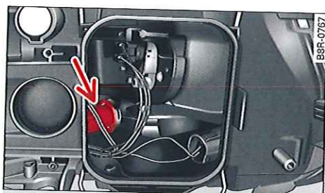
Fig. 252 Phare principal : ampoule du feu de position/feu de jour
