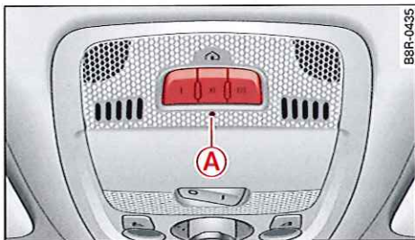
Fig. 36 Ciel de pavillon : unité de commande
