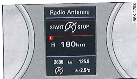
Fig. 103 Combiné d'instruments : fonction « arrêt du moteur » momentanément non disponible
