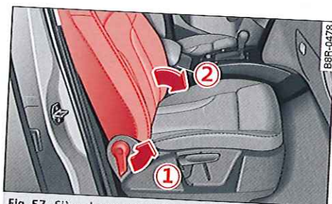
Fig. 57 Siège du passager avant : rabattement du dossier
