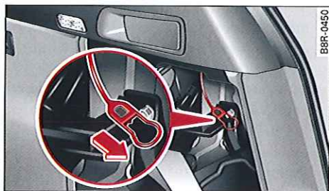
Fig. 196 Coffre à bagages : déverrouillage d'urgence du volet de réservoir
