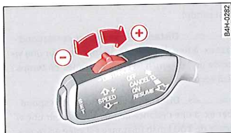
Fig. 137 Levier de commande : réglage de la distance
