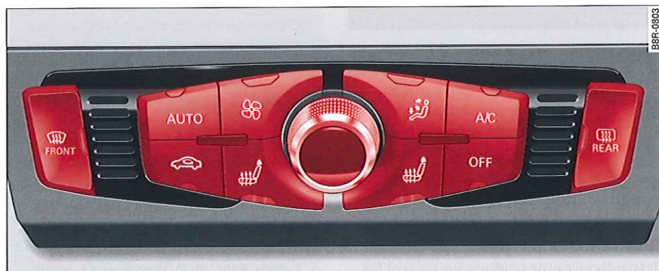
Fig. 93 Climatiseur automatique confort : commandes
