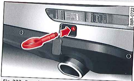
Fig. 233 Pare-chocs arrière : vissage de l'œillet de remorquage
