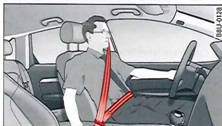
Fig. 137 Réglage de l'appui-tête et positionnement de la sangle
