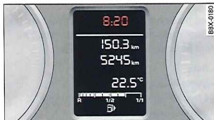
Fig. 9 Combiné d'instruments : réglage de l'heure sur les véhicules sans système d'information du conducteur
