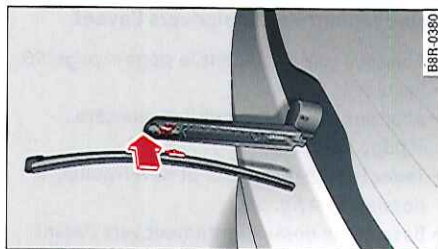
Fig. 53 Essuie-glace arrière : démontage du balai d'essuie-glace
