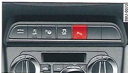
Fig. 108 Console centrale : touche d'aide au stationnement
