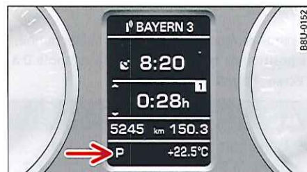
Fig. 90 Combiné d'instruments : positions du levier sélecteur
