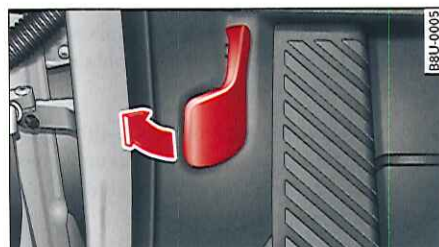
Fig. 165 Plancher côté conducteur : levier de déverrouillage
