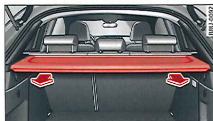
Fig. 71 Coffre à bagages : couvercle-coffre
