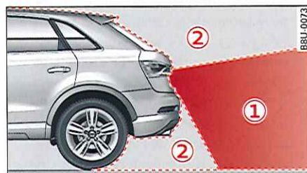
Fig. 112 Zone du champ de vision (1) et zone en dehors du champ de vision (2) de la caméra de recul
