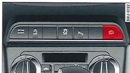
Fig. 155 Console centrale : touche de l'assistant de descente
