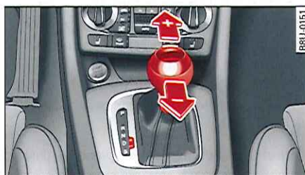
Fig. 92 Console centrale : passage manuel des rapports avec le levier sélecteur
