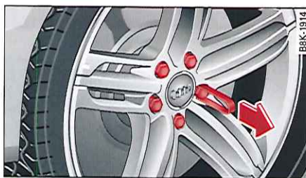
Fig. 186 Roue : boulons de roue avec capuchons de protection
