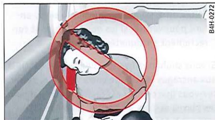
Fig. 127 Représentation schématique d'une position assise dangereuse dans la zone de déploiement de l'airbag latéral.
