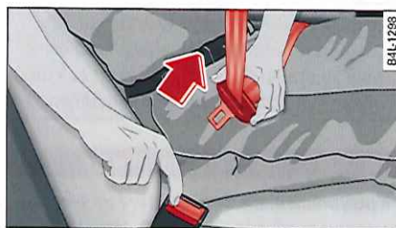
Fig. 142 Libération du pêne du boîtier de verrouillage
