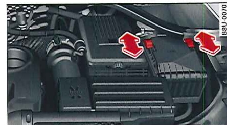
Fig. 202 Compartiment-moteur : déverrouillage du couvercle des fusibles
