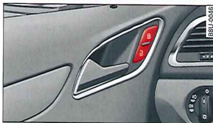
Fig. 29 Porte du véhicule : commande de verrouillage centralisé
