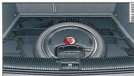
Fig. 193 Coffre à bagages : roue de secours plate (roue d'urgence)
