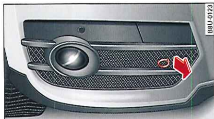
Fig. 197 Avant du véhicule : retrait du cache
