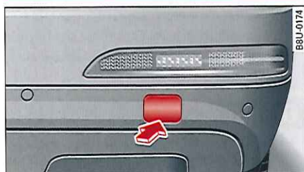
Fig. 199 Pare-chocs arrière : capuchon de protection
