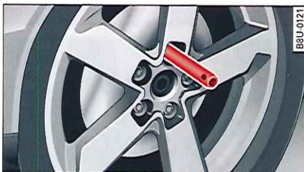
Fig. 192 Roue : axe de montage dans l'orifice supérieur
