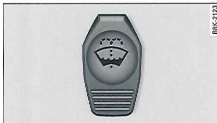
Fig. 173 Compartiment-moteur : réservoir de lave-glace
