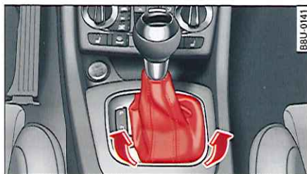
Fig. 94 Levier sélecteur : retrait du soufflet
