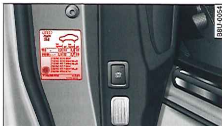
Fig. 174 Porte du conducteur ouverte avec tableau de la pression des pneus
