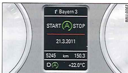
Fig. 86 Combiné d'instruments : moteur coupé (phase stop)
