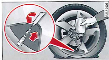
Fig. 184 Pneu : remplissage du pneu
