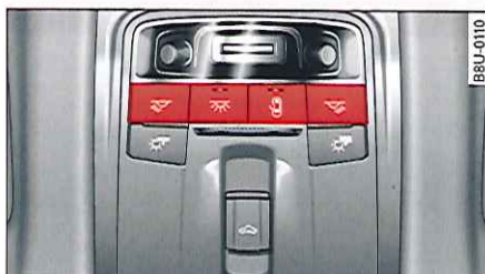
Fig. 44 Partie avant du ciel de pavillon : commandes du plafonnier
