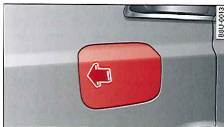
Fig. 162 Côté arrière droit du véhicule : ouverture du volet de réservoir
