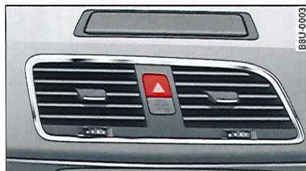
Fig. 43 Console centrale : touche du signal de détresse
