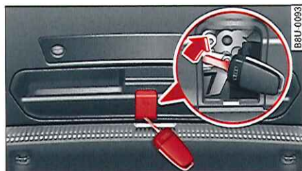
Fig. 34 Déverrouillage d'urgence du hayon
