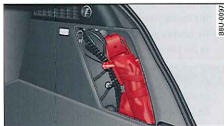
Fig. 180 Revêtement latéral droit du coffre à bagages : pochette d'outillage de bord et cric
