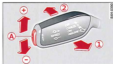
Fig. 89 Levier de commande : régulateur de vitesse
