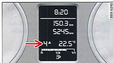
Fig. 12 Combiné d'instruments : indicateur de changement de rapport sur les véhicules sans système d'information du conducteur
