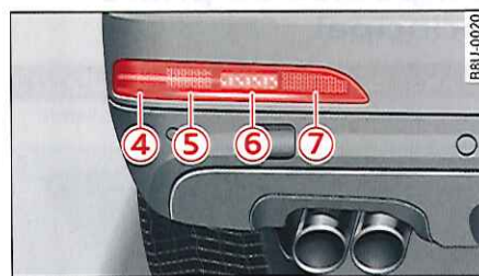
Fig. 206 Arrière du véhicule : ampoules dans le pare-chocs
