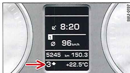
Fig. 13 Combiné d'instruments : indicateur de changement de rapport sur les véhicules avec système d'information du conducteur
