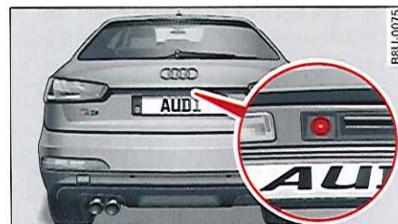
Fig. 113 Hayon : emplacement de montage de la caméra de recul
