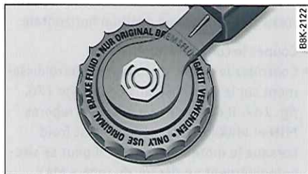
Fig. 171 Compartiment-moteur : repères sur le réservoir de liquide de frein
