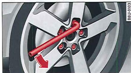
Fig. 188 Roue : desserrage des boulons de roue
