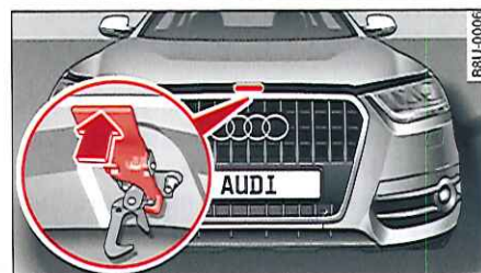
Fig. 166 Bouton à bascule sous le capot-moteur
