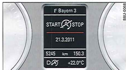
Fig. 87 Combiné d'instruments : fonction « arrêt du moteur » momentanément non disponible
