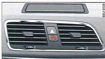
Fig. 153 Poste de conduite : témoin de désactivation de l'airbag passager
