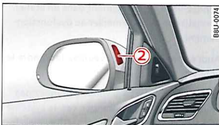
Fig. 101 Témoins dans le rétroviseur extérieur
