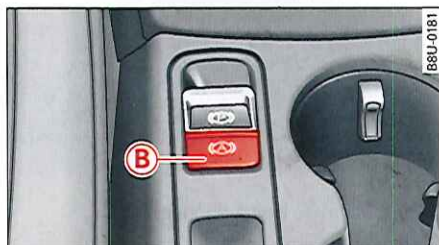
Fig. 85 Vue partielle de la console centrale : touche de l'assistant de démarrage
