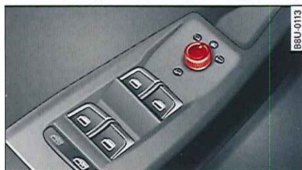
Fig. 47 Porte du conducteur : bouton rotatif des rétroviseurs extérieurs
