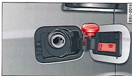
Fig. 163 Volet du réservoir avec bouchon de réservoir
