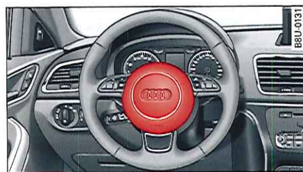
Fig. 144 Airbag conducteur intégré au volant de direction
