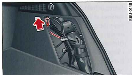
Fig. 164 Revêtement latéral droit du coffre à bagages : dispositif de déverrouillage d'urgence
