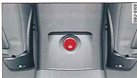
Fig. 64 Console centrale arrière : prise de courant de 12 volts
