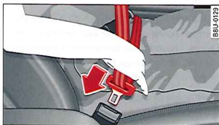
Fig. 138 Siège du conducteur : boîtier de verrouillage et pêne
