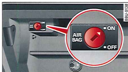
Fig. 152 Boîte à gants : commande à clé permettant de désactiver l'airbag du passager avant
