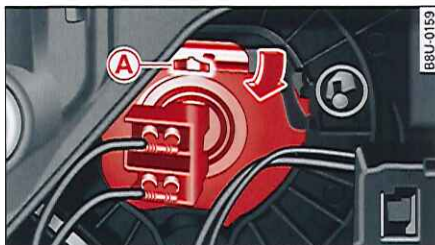
Fig. 212 Connecteur en plastique : repose du feu de croisement
