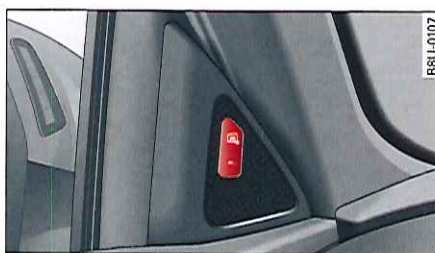
Fig. 104 Porte conducteur : touche du système side assist
