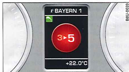
Fig. 18 Combiné d'instruments : indicateur élargi de changement de rapport sur les véhicules dotés d'un écran multicolore
