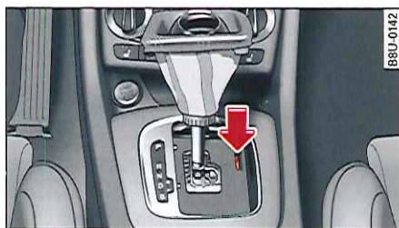
Fig. 95 Levier sélecteur : déverrouillage d'urgence
