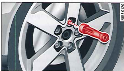
Fig. 191 Roue : six pans creux pour le serrage des boulons de roue
