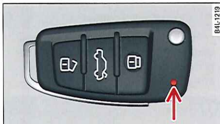
Fig. 25 Clé à radiocommande : LED
