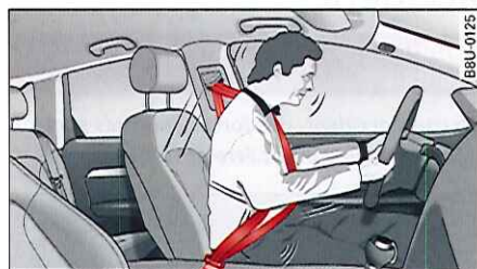
Fig. 132 Conducteur attaché, retenu en cas de freinage brusque par la ceinture correctement positionnée.
