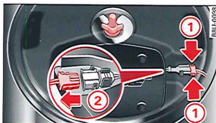
Fig. 194 Cuvelage de la roue de secours : caisson de basses
