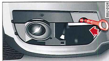
Fig. 198 Avant du véhicule : vissage de l'œillet de remorquage
