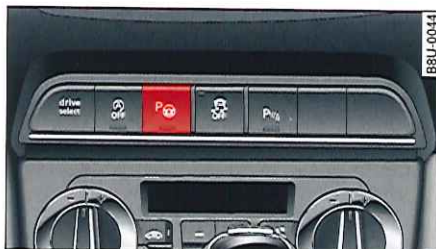
Fig. 120 Console centrale : touche de l'assistant aux manœuvres de stationnement
