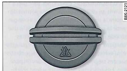
Fig. 170 Compartiment-moteur : repères sur le vase d'expansion de liquide de refroidissement
