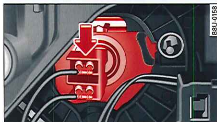
Fig. 211 Connecteur en plastique : dépose du feu de croisement
