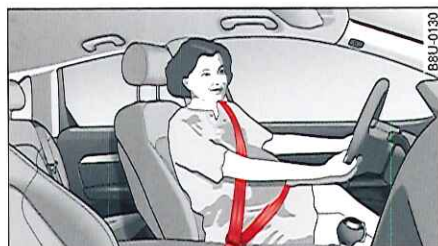
Fig. 140 Positionnement des sangles recommandé pour les femmes enceintes
