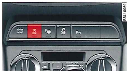
Fig. 88 Console centrale : touche du système start/stop
