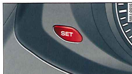
Fig. 10 Côté gauche du combiné d'instruments : touche SET
