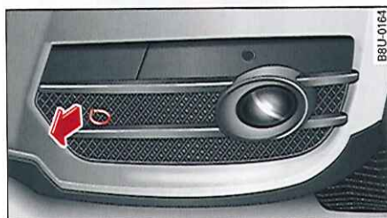
Fig. 218 Phare antibrouillard : retrait du cache
