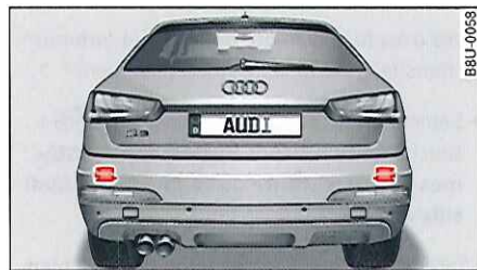
Fig. 103 Arrière du véhicule : position des capteurs
