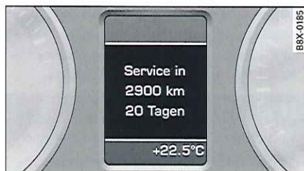
Fig. 15 Combiné d'instruments : indicateur de périodicité d'entretien sur les véhicules avec système d'information du conducteur
