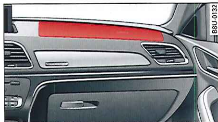
Fig. 145 Airbag passager avant intégré au tableau de bord
