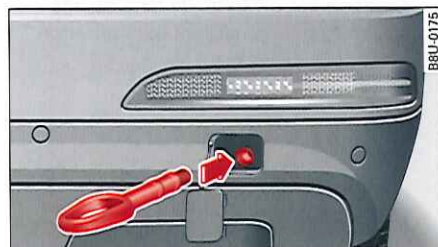
Fig. 200 Pare-chocs arrière : vissage de l'œillet de remorquage
