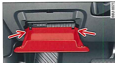
Fig. 201 Poste de conduite côté conducteur : abaissement du casier de rangement
