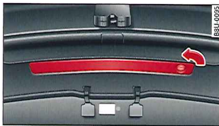
Fig. 178 Triangle de présignalisation dans le hayon
