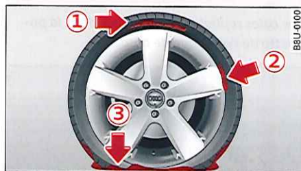
Fig. 183 Pneu : dommages irréparables sur le pneu
