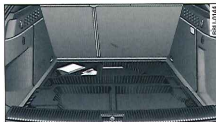
Fig. 77 Coffre à bagages : double plancher de chargement
