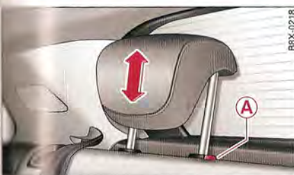
Fig. 59 Siège arrière : réglage et dépose/repose de l'appuie-tête
