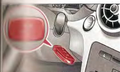
Fig. 81 Colonne de direction/clé à radiocommande : fonctionnement du moteur en cas de perturbation
