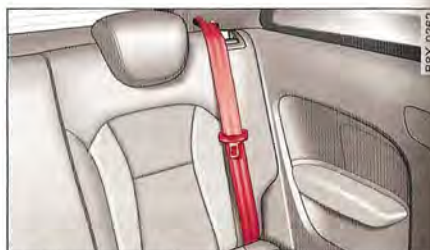
Fig. 117 Guidage de la ceinture des places arrière gauche et droite
