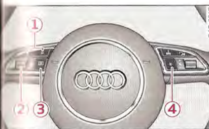
Fig. 17 Volant multifonction : commandes de l'ordinateur de bord
