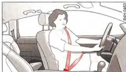
Fig. 116 Positionnement de la sangle recommandé pour les femmes enceintes
