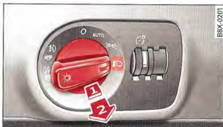
Fig. 39 Tableau de bord : commande d'éclairage avec phares à commande automatique
