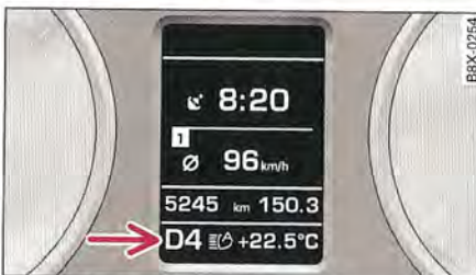
Fig. 92 Écran (avec système d'information du conducteur) : positions du levier sélecteur
