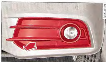
Fig. 202 Partie avant gauche : extraction du cache
