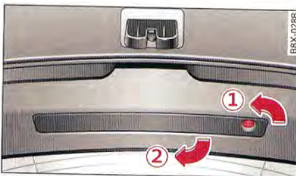
Fig. 162 Triangle de présignalisation dans le hayon
