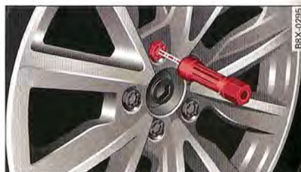
Fig. 172 Changement de roue : six pans creux pour le serrage des boulons
