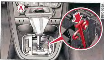
Fig. 99 Levier sélecteur : déverrouillage d'urgence de la position de parking
