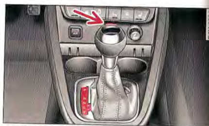
Fig. 94 Vue partielle de la console centrale : levier sélecteur avec touche de blocage
