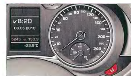
Fig. 7 Combiné d'instruments : compteur kilométrique et touche de remise à zéro
