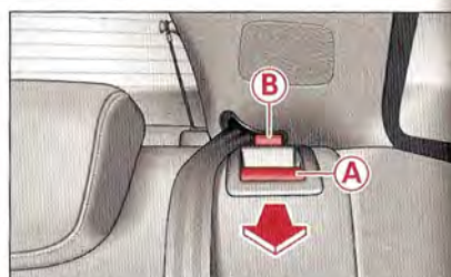
Fig. 70 Levier de déverrouillage du dossier de banquette arrière (côté gauche).
