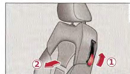
Fig. 55 Siège du conducteur : commande de déverrouillage du dossier
