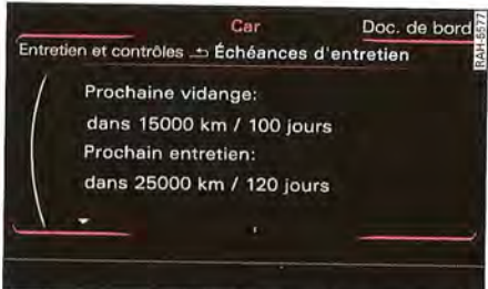
Fig. 19 Écran de l'autoradio ou du MMI sur le tableau de bord : indicateur de périodicité d'entretien
