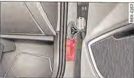
Fig. 215 Porte droite ouverte : plaque du constructeur
