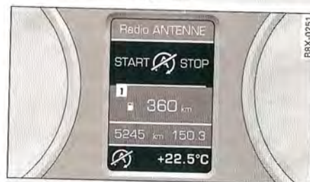
Fig. 89 Combiné d'instruments avec système d'information du conducteur : fonction « arrêt du moteur » temporairement non disponible
