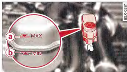
Fig. 153 Compartiment-moteur : repères sur le réservoir de liquide de frein
