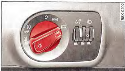
Fig. 40 Tableau de bord : commande d'éclairage avec réglage du site des phares
