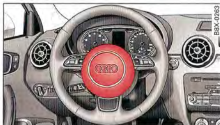
Fig. 119 Airbag conducteur intégré au volant de direction
