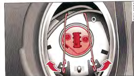
Fig. 193 Boîtier de l'ampoule : dépose de l'ampoule de feux de route
