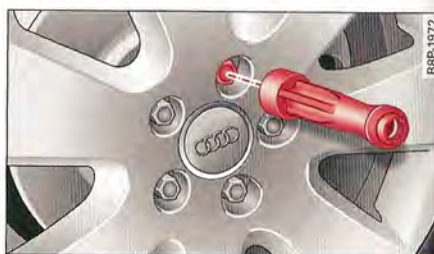
Fig. 168 Changement de roue : retrait des capuchons de protection
