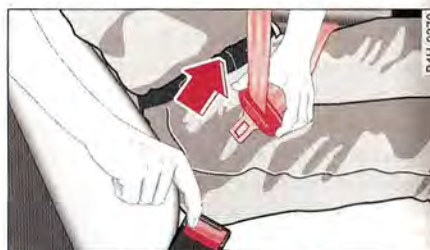
Fig. 118 Libération du pêne du boîtier de verrouillage
