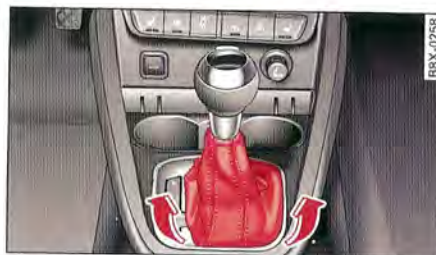
Fig. 98 Levier sélecteur : retrait du cache
