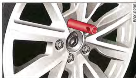
Fig. 173 Changement de roue : axe de montage dans l'orifice supérieur
