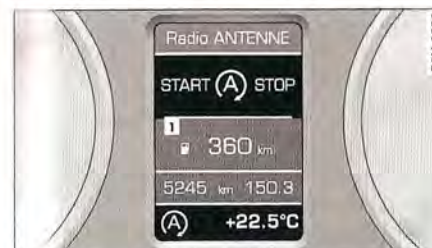
Fig. 87 Combiné d'instrument avec système d'information du conducteur : moteur coupé (phase stop)
