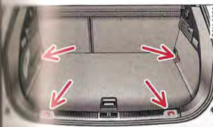
Fig. 71 Emplacements des œillets d'arrimage dans le coffre à bagages
