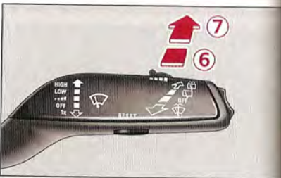
Fig. 51 Levier d'essuie-glaces : commande de l'essuie-glace arrière
