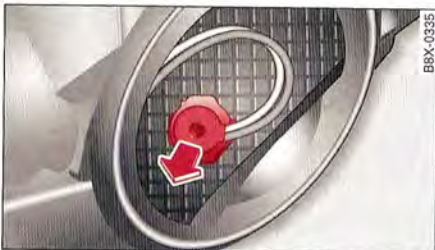
Fig. 197 Boîtier de l'ampoule : dépose de l'ampoule de clignotant
