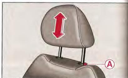
Fig. 58 Siège avant : réglage et dépose/repose de l'appuie-tête
