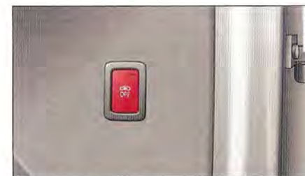
Fig. 33 Porte du conducteur ouverte, revêtement latéral : touche du dispositif de surveillance de l'habitacle et du dispositif anti-remorquage
