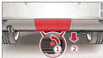
Fig. 134 Zone du pare-chocs arrière : retrait du cache du pare-chocs
