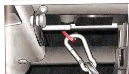
Fig. 138 Dispositif d'attelage avec sécurisation par câble de retenue (dans l'exemple : câble de retenue attaché)
