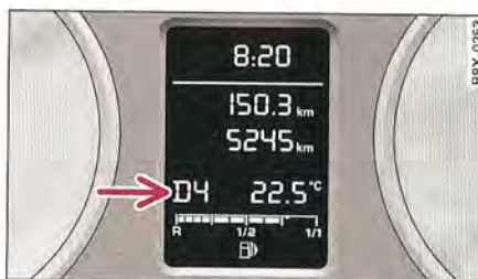
Fig. 91 Écran (sans système d'information du conducteur) : positions du levier sélecteur
