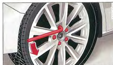
Fig. 169 Changement de roue : desserrage des boulons de roue
