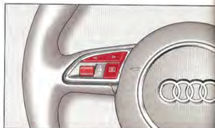
Fig. 16 Volant multifonction : commandes de l'ordinateur de bord
