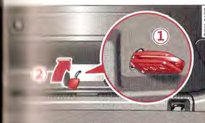
Fig. 36 Vue partielle du coffre à bagages : accès au déverrouillage d'urgence
