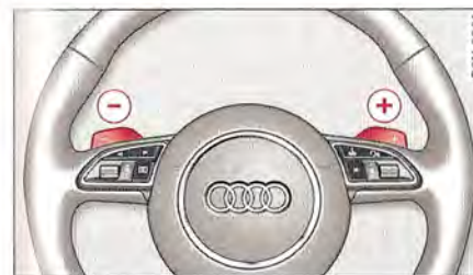
Fig. 97 Volant : commandes tiptronic
