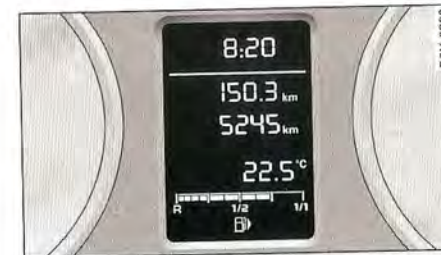
Fig. 8 Combiné d'instruments : écran sans système d'informations du conducteur
