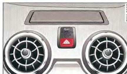
Fig. 44 Poste de conduite : touche du signal de détresse
