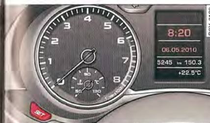
Fig. 6 Combiné d'instruments : affichage de l'heure et de la date
