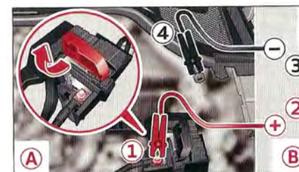
Fig. 178 Version 2) Compartiment-moteur avec prises de démarrage assisté : démarrage de fortune avec la batterie d'un autre véhicule : (A) - batterie déchargée, (B) - batterie fournissant le courant
