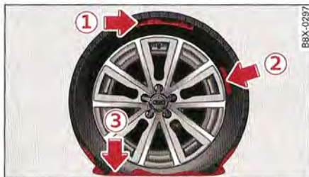
Fig. 175 Dommages pour lesquels le kit anticrevaillon ne convient pas
