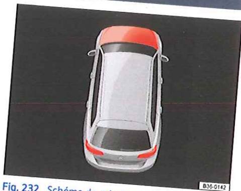
Fig. 232 Schéma de principe sur l'afficheur du combiné d'instruments : capot-moteur ouvert ou pas fermé correctement
