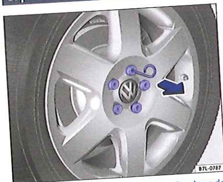
Fig. 262 Retrait des capuchons des boulons de roue.
