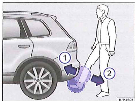
Fig. 38 Système sans clé de fermeture et de démarrage Keyless Access : capot arrière à ouverture pilotée par capteur (Easy Open) pour différentes assiettes du véhicule.
