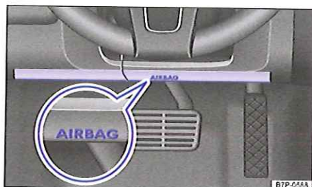
Fig. 93 Côté conducteur : emplacement de montage du sac gonflable de genoux
