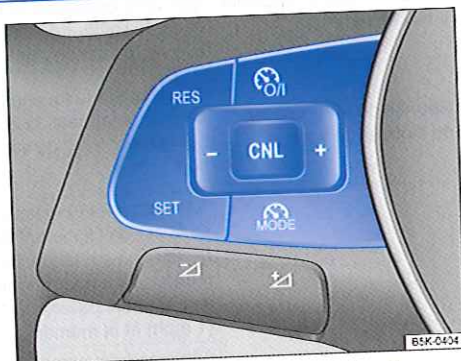
Fig. 187 Côté gauche du volant multifonction : touches de commande du limiteur de vitesse.
