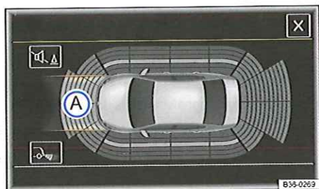
Fig. 163 Affichage à l'écran du système d'aide au stationnement (ParkPilot) : indicateur de trajet sans braquage
