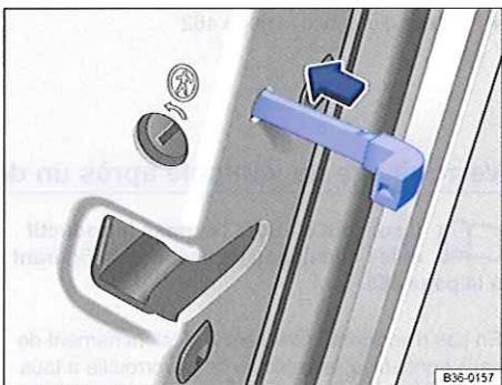
Fig. 247 Sur le chant de la porte arrière droite : verrouillage d'urgence du véhicule à l'aide de la clé de secours
