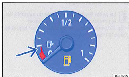
Fig. 220 Dans le combiné d'instruments : indicateur de niveau de carburant
