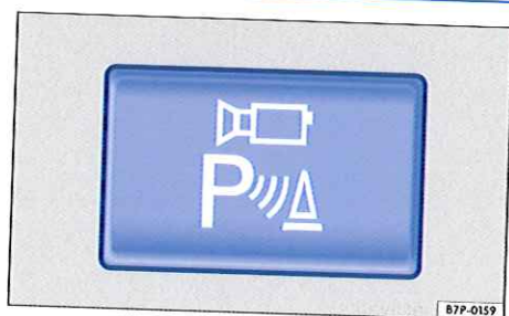
Fig. 180 Dans la partie supérieure de la console centrale : touche d'activation manuelle de la vision périphérique.
