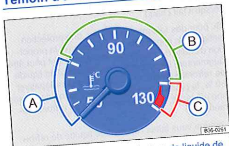
Fig. 229 Indicateur de température de liquide de refroidissement dans le combiné d'instrument : (A) Zone froide; (B) Zone normale; (C) Zone d'alerte.
