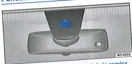
Fig. 202 Sur le pare-brise : regard de la caméra de l'assistant de maintien de voie
