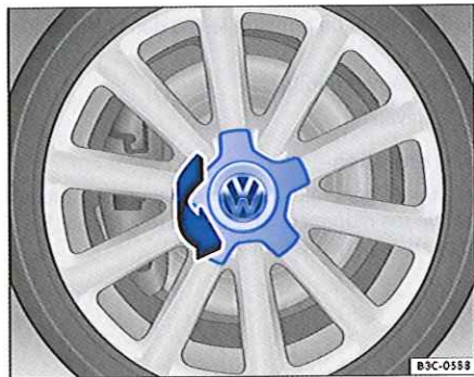
Fig. 254 Dévissage de l'enjoliveur central.
