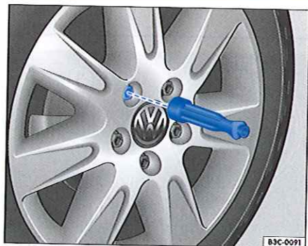
Fig. 265 Changement d'une roue : dévissage des boulons de roue à l'aide du manche de tournevis.
