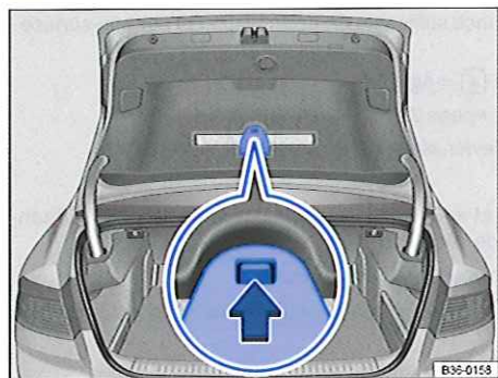
Fig. 244 Dans le capot de coffre : support du triangle de présignalisation.
