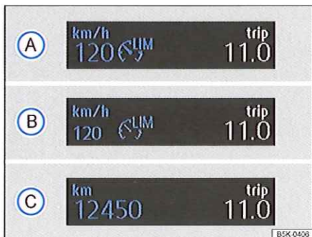
Fig. 185 Sur l'afficheur du combiné d'instruments : indications sur l'état du limiteur de vitesse.
