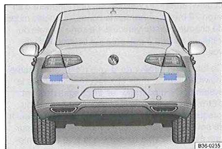
Fig. 204 Vue de derrière du véhicule : zones des capteurs à radar
