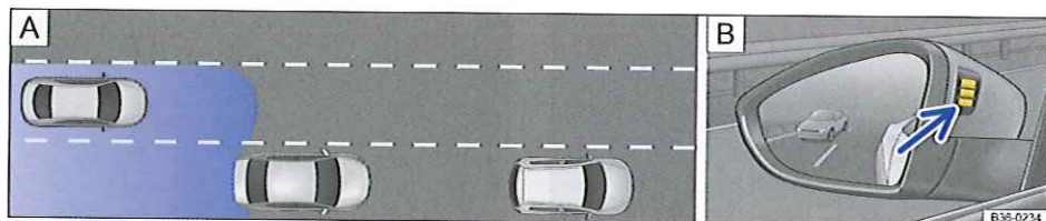
Fig. 205 A) Situation de conduite lors d'un dépassement avec circulation à l'arrière B) Signal optique dans le rétroviseur extérieur gauche
