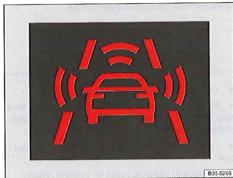
Fig. 197 Afficheur du combiné d'instruments : avertissement préalable.
