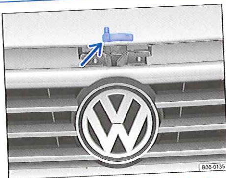
Fig. 226 Au-dessus de la grille de calandre : levier de déverrouillage permettant d'ouvrir le capot-moteur
