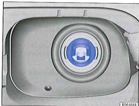
Fig. 222 Trappe à carburant ouverte : détrompeur de ravitaillement dans la goulotte de remplissage de carburant
