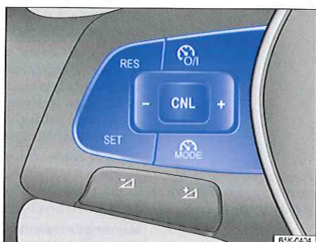
Fig. 184 Côté gauche du volant multifonction : touches pour l'utilisation du régulateur de vitesse
