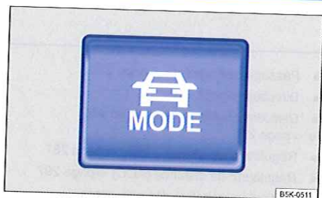
Fig. 211 Dans la partie inférieure de la console centrale : touche de sélection du profil de conduite.
