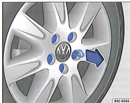
Fig. 256 Retrait des capuchons de boulons de roue.
