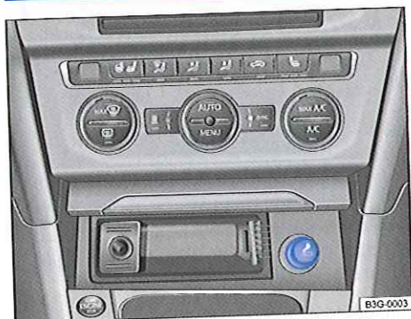
Fig. 138 Dans la console centrale avant : allume-cigare dans le cendrier (variante 1)
