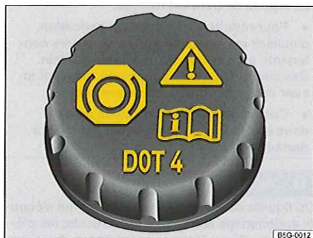
Fig. 155 Dans le compartiment-moteur : bouchon du réservoir de liquide de frein.
