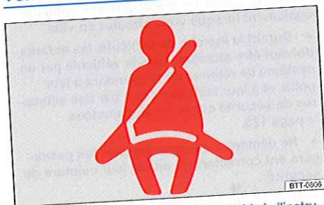
Fig. 71 Témoin d'alerte dans le combiné d'instruments.
