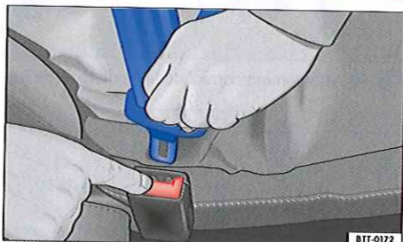
Fig. 79 Libération du pêne du boîtier de verrouillage
