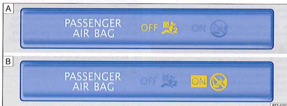
Fig. 83 Dans la partie supérieure de la console centrale : témoin de désactivation du sac gonflable du passager avant (variante [A]) ou d'activation du sac gonflable frontal du passager avant (variante [B]).
