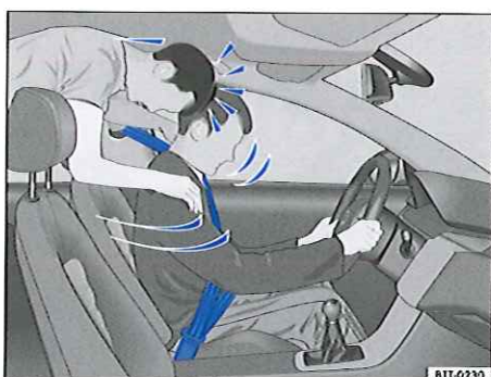
Fig. 76 Le passager arrière non attaché est projeté en avant et vient heurter le conducteur attaché.
