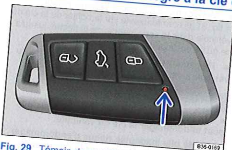
Fig. 29 Témoin de contrôle intégré à la clé du véhicule
