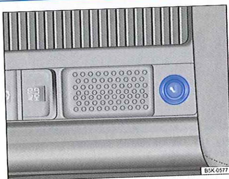
Fig. 139 Dans la partie inférieure de la console centrale : allume-cigare (variante 2)
