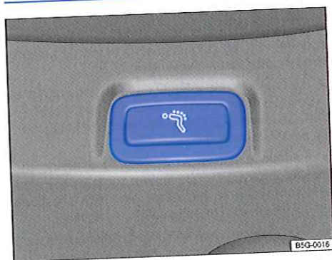
Fig. 69 À l'extérieur du siège avant : touche de la fonction de massage dorsal. La touche peut être combinée à d'autres éléments de commande.
