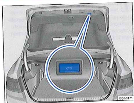
Fig. 47 Dans le capot de coffre ouvert : touche de fermeture électrique du capot de coffre.
