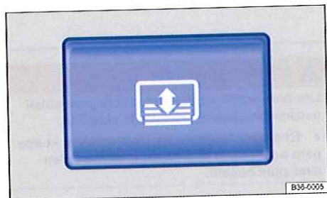
Fig. 104 Dans la console centrale : touche pour store pare-soleil électrique de glace arrière.
