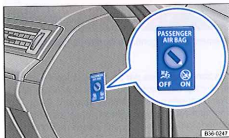
Fig. 86 Dans le tableau de bord côté passager avant : commande à clé de désactivation et d'activation du sac gonflable frontal du passager avant
