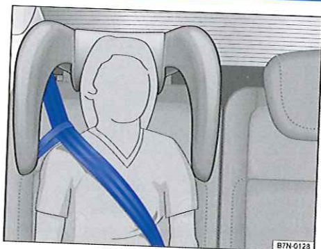
Fig. 98 Siège intégré pour enfants : ajustement de la ceinture avec la boucle de guidage de la ceinture
