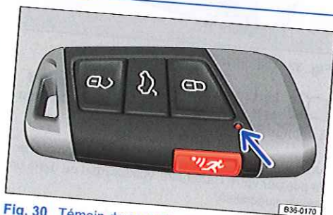
Fig. 30 Témoin de contrôle intégré à la clé du véhicule
