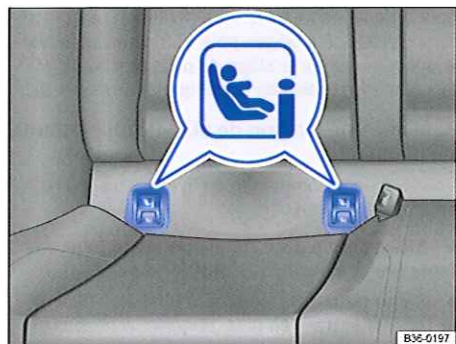
Fig. 92 Sur le siège du véhicule : variantes d'identification des points d'ancrage ISOFIX des sièges pour enfants
