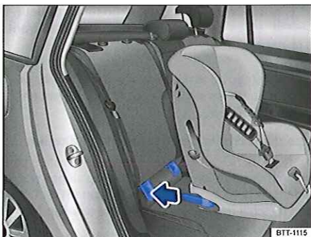
Fig. 93 Schéma de principe : installation d'un siège pour enfants ISOFIX avec verrous
