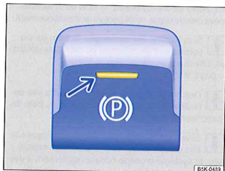
Fig. 153 Dans la partie inférieure de la console centrale : touche du frein de stationnement électronique.
