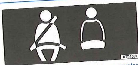
Fig. 72 Indicateur de statut des ceintures pour les places arrière dans le combiné d'instruments.
