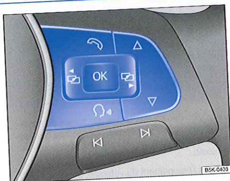
Fig. 20 Côté droit du volant multifonction : touches de commande des menus et des informations sur le combiné d'instruments
