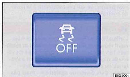
Fig. 154 Dans la partie inférieure de la console centrale : touche de désactivation et d'activation manuelles de l'ASR
