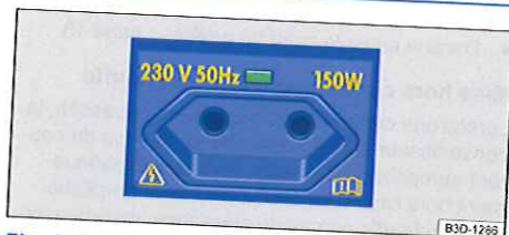
Fig. 141 Prise de courant européenne 230 volts.
