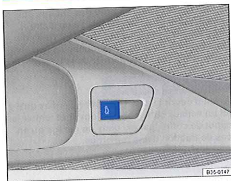
Fig. 44 Dans la porte du conducteur : touche de déverrouillage du capot de coffre.
