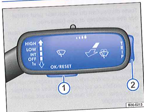
Fig. 19 Véhicules sans volant multifonction : touche ① du levier d'essuie-glace (à droite sur la colonne de direction) pour valider les options et commande à bascule ② pour changer de menu et afficher des informations
