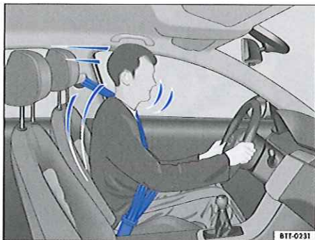
Fig. 77 Conducteur correctement attaché, retenu par sa ceinture de sécurité lors d'un freinage brusque.
