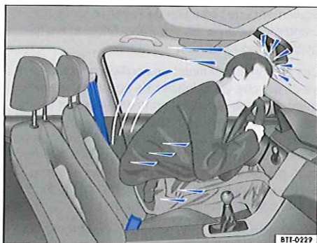
Fig. 75 Le conducteur non attaché est projeté en avant.
