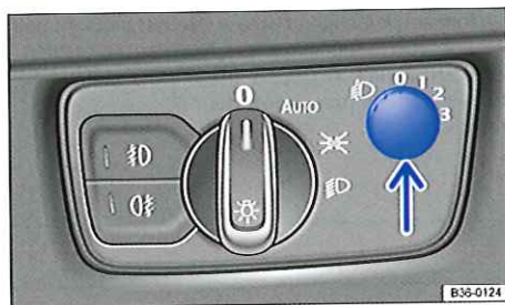
Fig. 102 À côté du volant : molette de réglage du site des projecteurs (flèche)
