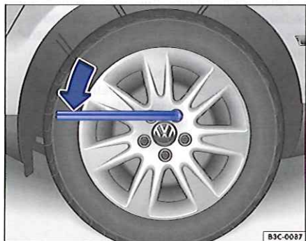
Fig. 240 Changement de roue : desserrage des boulons de roue
