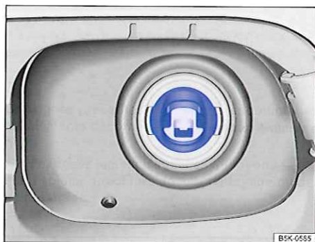
Fig. 205 Trappe à carburant ouverte : détrompeur de ravitaillement dans la goulotte de remplissage de carburant
