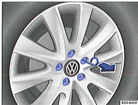
Fig. 239 Retrait des capuchons des boulons de roue.
