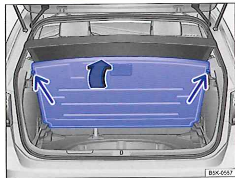
Fig. 234 Dans le coffre à bagages : plancher de coffre à bagages relevé
