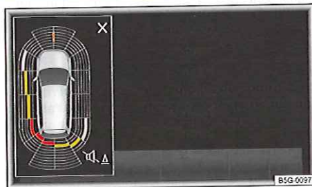
Fig. 158 Affichage à l'écran en format réduit du système d'aide au stationnement (mini ParkPilot) autour du véhicule
