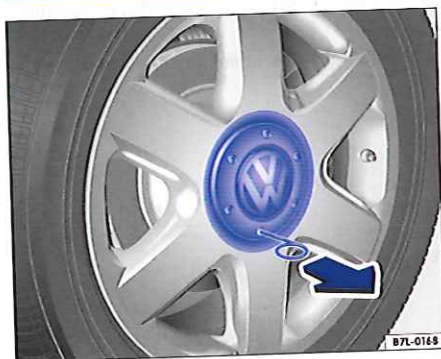
Fig. 236 Extraction de l'enjoliveur central en tirant
