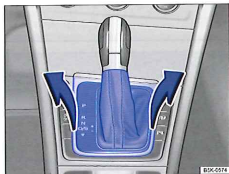
Fig. 232 Dépose du cache de la grille de guidage
