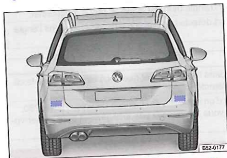
Fig. 190 Vue de derrière du véhicule : zones des capteurs radars
