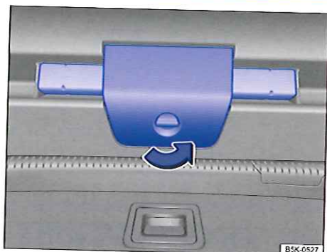
Fig. 230 Dans le hayon : ouverture du support du triangle de présignalisation
