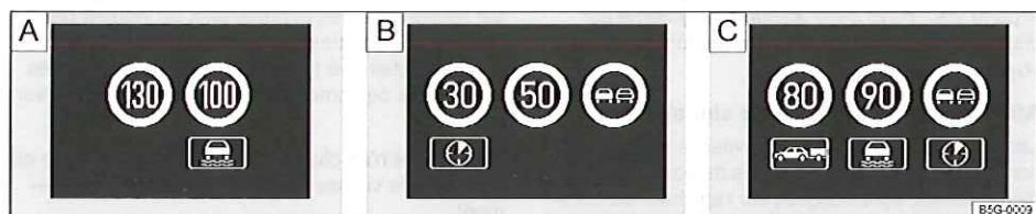
Fig. 194 Sur l'afficheur du combiné d'instruments : exemples de panneaux de limitation de vitesse et d'interdiction de dépasser détectés avec les panneaux supplémentaires correspondants
