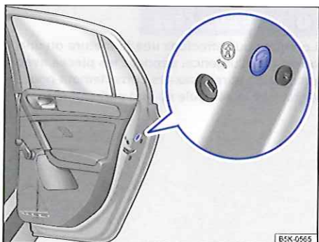
Fig. 228 Sur le chant de la porte arrière droite : verrouillage d'urgence masqué par un joint en caoutchouc.
