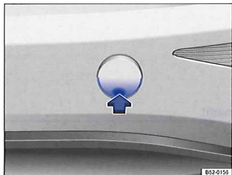
Fig. 269 Dans le pare-chocs arrière droit : retrait du cache
