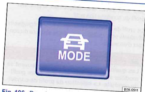
Fig. 196 Dans la partie inférieure de la console centrale : touche de sélection du profil de conduite
