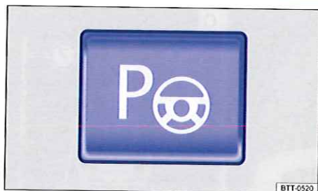
Fig. 165 Dans la partie inférieure de la console centrale : touche d'activation de l'assistant aux manœuvres de stationnement
