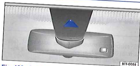
Fig. 188 Sur le pare-brise : lucarne de la caméra de l'assistant de maintien de voie
