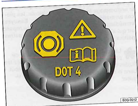
Fig. 151 Dans le compartiment-moteur : bouchon du réservoir de liquide de frein.
