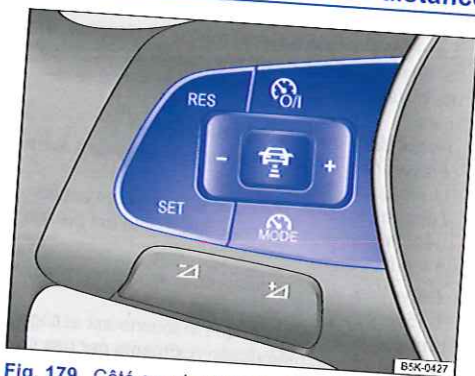
Fig. 179 Côté gauche du volant multifonction : touches de commande du régulateur de distance
