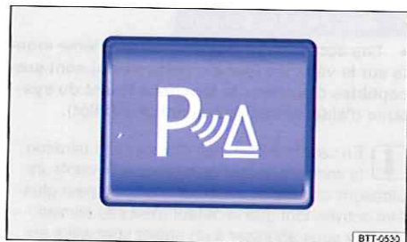
Fig. 156 Dans la partie inférieure de la console centrale : touche d'activation et de désactivation du système d'aide au stationnement (ParkPilot).
