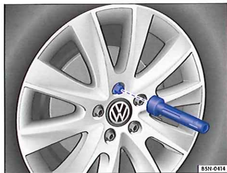
Fig. 245 Changement de roue : dévissage des boulons de roue à l'aide du manche de tournevis.
