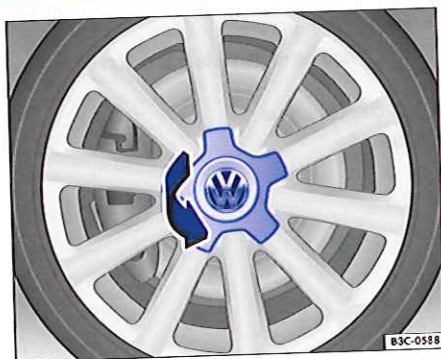
Fig. 237 Retrait de l'enjoliveur central par un mouvement de rotation
