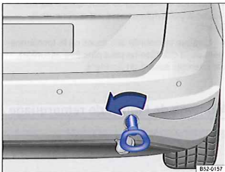
Fig. 270 Dans le pare-chocs arrière droit : vissage de l'œillet de remorquage
