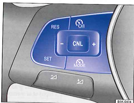
Fig. 174 Côté gauche du volant multifonction : touches de commande du limiteur de vitesse
