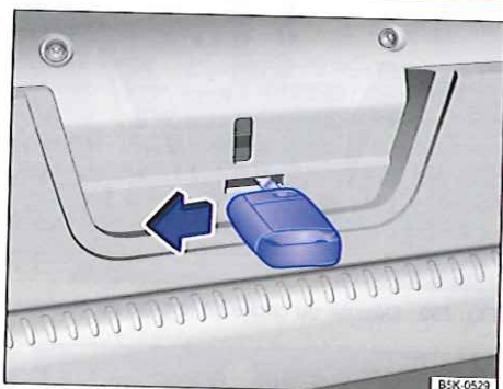
Fig. 231 Dans le coffre à bagages : déverrouillage du hayon
