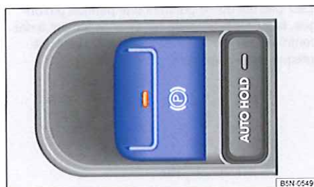
Fig. 148 Dans la partie inférieure de la console centrale : touche du frein de stationnement électronique.
