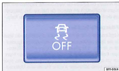
Fig. 149 Dans la console centrale : touche de désactivation et d'activation manuelles de l'ASR.
