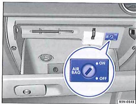
Fig. 73 Dans la boîte à gants : commande à clé de désactivation et d'activation du sac gonflable frontal du passager avant
