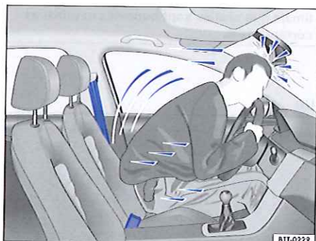
Fig. 62 Le conducteur non attaché est projeté en avant.
