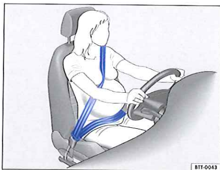
Fig. 68 Ajustement correct de la sangle recommandé pour les femmes enceintes
