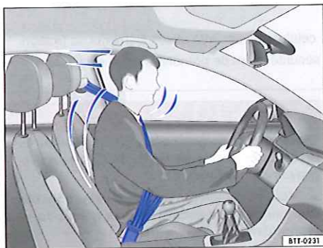
Fig. 64 Conducteur correctement attaché, retenu par sa ceinture de sécurité lors d'un freinage brusque.
