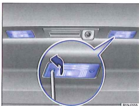
Fig. 242 Dans le hayon : feu de plaque de police vissé.
