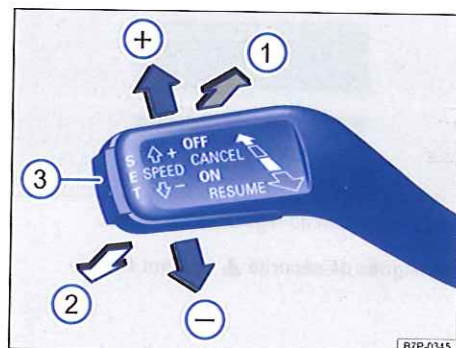
Fig. 169 À gauche de la colonne de direction : levier de commande du régulateur de vitesse.
