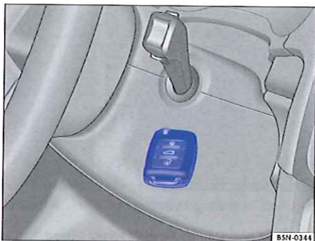
Fig. 140 Fonction de démarrage d'urgence sur les véhicules équipés du système Keyless Access
