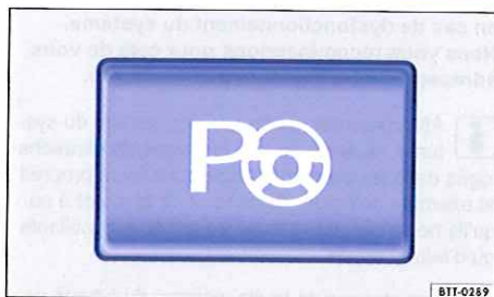
Fig. 164 Dans la partie inférieure de la console centrale : touche d'activation de l'assistant aux manœuvres de stationnement.
