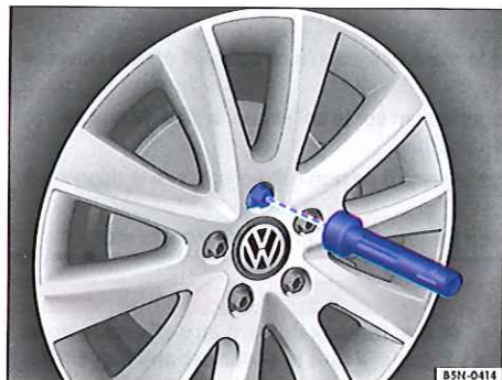
Fig. 227 Changement d'une roue : dévissage des boulons de roue à l'aide du manche de tournevis.
