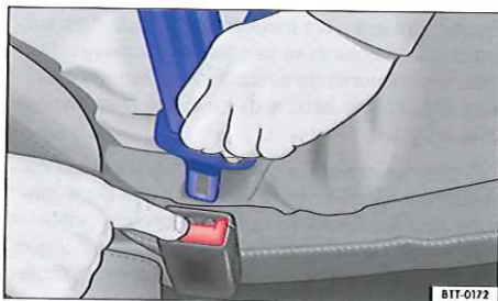
Fig. 66 Libération du pêne du boîtier de verrouillage.
