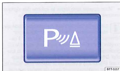
Fig. 156 Dans la partie inférieure de la console centrale : touche d'activation et de désactivation du système d'aide au stationnement ParkPilot (selon l'équipement du véhicule).
