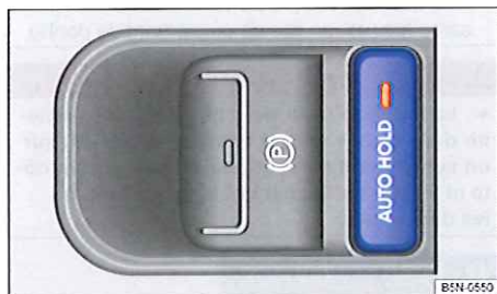
Fig. 152 Dans la partie inférieure de la console centrale : touche de la fonction Auto Hold.
