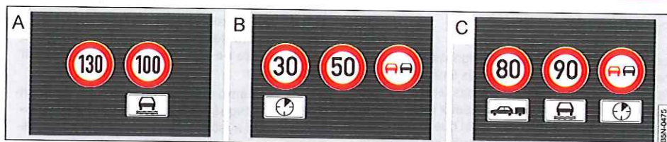
Fig. 172 Sur l'afficheur du combiné d'instruments : exemples de panneaux de limitation de vitesse et d'interdiction de dépasser détectés avec les panneaux supplémentaires correspondants.
