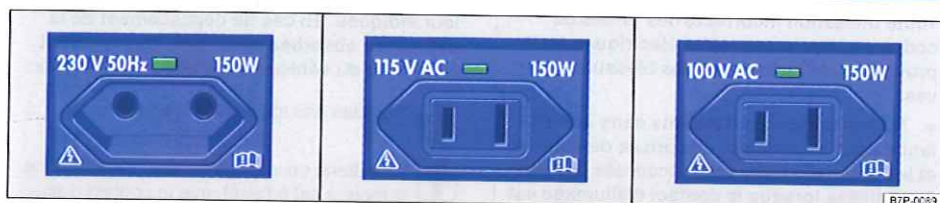
Fig. 136 Entre les sièges avant, à l'arrière : prise de courant européenne 230 volts, prise de courant 115 volts ou prise de courant 100 volts
