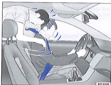
Fig. 63 Le passager arrière non attaché est projeté en avant et vient heurter le conducteur attaché.
