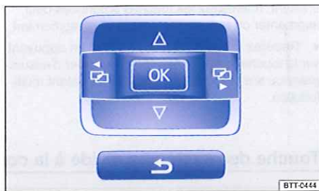
Fig. 16 Côté droit du volant multifonction : touches de commande des menus sur l'afficheur du combiné d'instruments.
