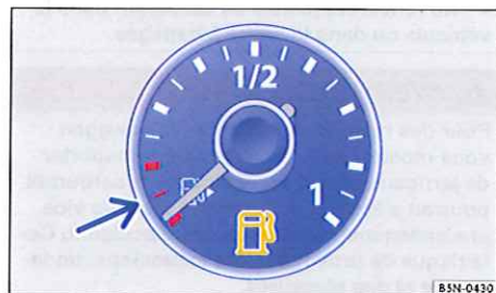
Fig. 182 Dans le combiné d'instruments : indicateur de niveau de carburant (essence et gazole).
