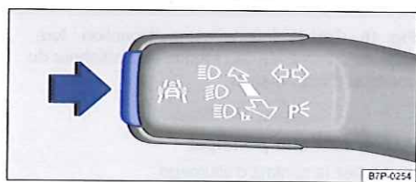
Fig. 17 Dans le levier des clignotants et de l'inverseur-codes : touche des systèmes d'aide à la conduite.
