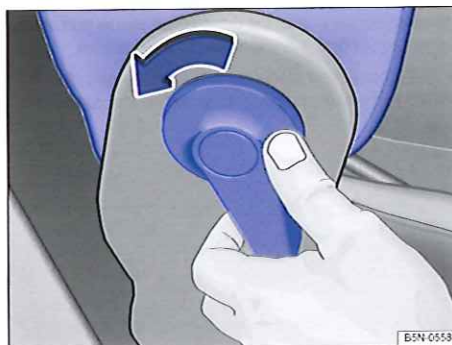
Fig. 58 Déverrouillage du dossier de siège escamotable du passager avant.
