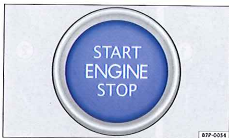
Fig. 139 Dans la partie inférieure de la console centrale : bouton de démarrage du système sans clé de fermeture et de démarrage Keyless Access.
