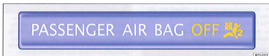
Fig. 70 Dans la partie supérieure de la console centrale : témoin de désactivation du sac gonflable du passager avant
