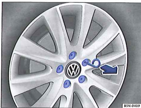
Fig. 222 Retrait des capuchons de boulons de roue
