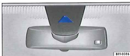
Fig. 171 Sur le pare-brise : regard de la caméra de l'assistant de maintien de voie.
