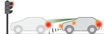
Cette fonction, également appelée "Active Safety Brake", intervient après l'alerte sonore si le conducteur n'appuie pas assez vite sur la pédale de frein.
