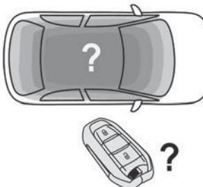
Lorsque la clé électronique n'est pas détectée ou n'est plus dans la zone de reconnaissance, un message apparaît au combiné d'instruments à la fermeture d'un ouvrant ou à la demande de l'arrêt du moteur.
