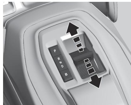
Le sélecteur de conduite est un sélecteur à impulsions avec fonction de freinage par récupération.
