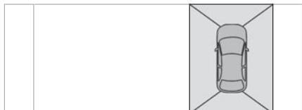
Les vues avant et arrière apparaissent automatiquement dans la vue de dessus du véhicule.
