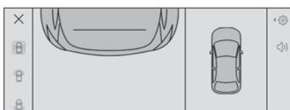
La caméra avant ou arrière enregistre les alentours lors de la manœuvre pour créer une vue de dessus avant ou arrière du véhicule dans son environnement proche, permettant de réaliser une manœuvre du véhicule avec les obstacles environnants.
