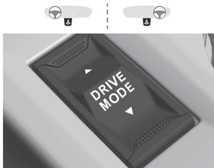
► Appuyer sur la commande pour afficher les modes au combiné d'instruments.
