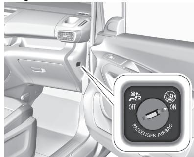
Le système d'airbag du passager avant peut être désactivé via un commutateur côté passager du combiné d'instruments.
