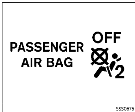
Témoin d'état du coussin gonflable du passager avant
